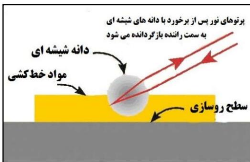
تصویر (2) : نحوه عملکرد دانه های شیشه ای در خط کشی های ترافیکی
