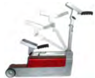
تصویر (۵) : نمونه‌های دستگاه‌سنجش بازتاب نور برگشتی
