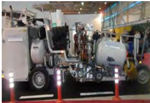
تصویر (۱۲): نمونه‌ای از خودرو خظزن محوری با رنگ دوجزئی
