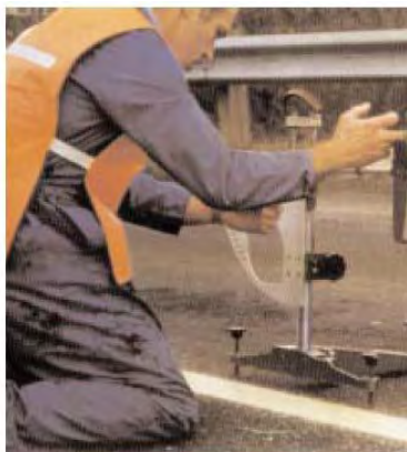
تصویر (۲۰): دستگاه و نحوه اندازه‌گیری مقاومت در برابر سُر خوردگی خط‌کشی‌ها
