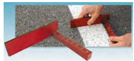
تصویر (۷) : نمونه‌های دستگاه‌های سنجش ضخامت فیلم خشک خط‌کشی
