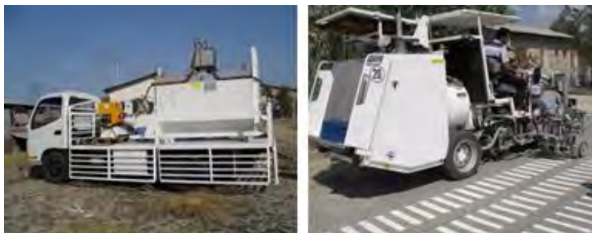
تصویر (۱۱): نمونه‌ای از تجهیزات اجرای خط‌کشی با رنگ گرم
