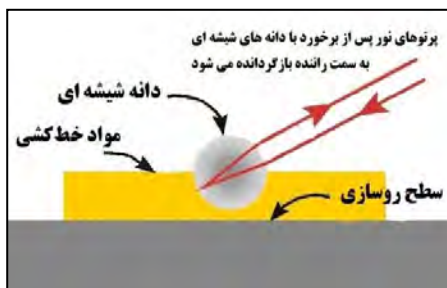
تصویر (۲): نحوه عملکرد دانه‌های شیشه‌ای در خط‌کشی‌های ترافیکی
