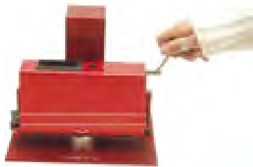
تصویر (۶) : نمونه دستگاه‌سنجش فاکتور روشنایی
