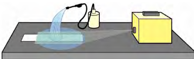
روش پاشش آب بر سطح خط‌کشی به‌منظور شبیه‌سازی شرایط بارانی
