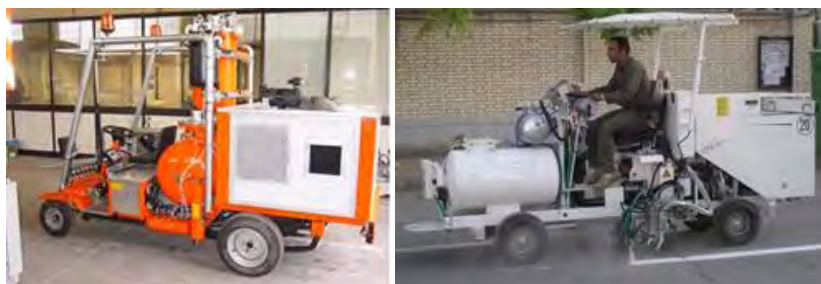
تصویر (۱۰): نمونه ماشین خطکشی رنگ سرد
