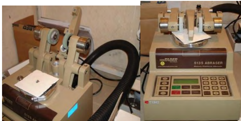
قرار دادن نمونه در دستگاه و بارگذاری وزنه یک کیلوگرمی (دو وزنه ۵۰۰ گرمی) روی آن تصویر (۲۱): مراحل انجام آزمون تعیین مقاومت سایشی با دستگاه TABER
