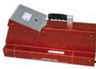
تصویر (۵) : نمونه‌های دستگاه‌سنجش بازتاب نور برگشتی
